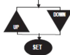
Valores entre 2 – 1800 segundos se ajustan usando botones UP-DOWN.
